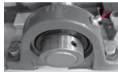
FIGURE 22. Pomper de la graisse aux deux points de graissage de roulement de rotor, un de chaque côté du rotor.
