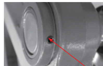
FIGURE 24. Les vis de blocage de roulement, une de chaque côté du rotor, devraient être vérifiés tous les six mois pour le serrage.
