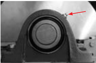
FIGURE 35. La graisse doit être pompée dans deux points de graissage de roulement de rotor, un situé de chaque côté du rotor. La fréquence de lubrification dépend des températures de fonctionnement normalement observées autour du rotor.
