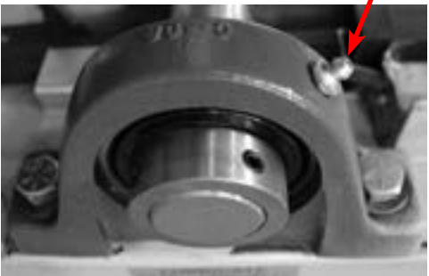
FIGURE 16. Inspectez le collier de palier pour vous assurer que tous les boulons et vis sont serrés.
