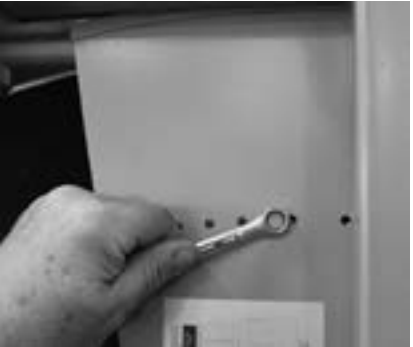
FIGURE 29. Pour ajuster la purge, retirez le boulon de réglage.
