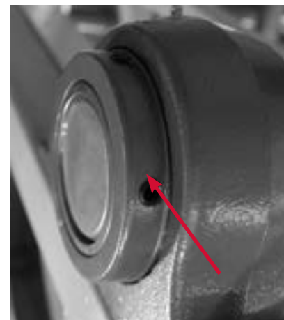
FIGURE 47. Les vis de fixation du palier, une de chaque côté du rotor, doivent être vérifiées pour leur serrage tous les six mois.
