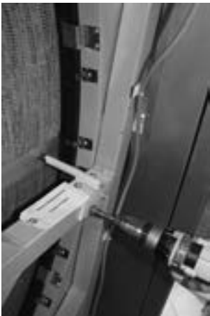
FIGURE 13. Dispositif de retenue d'expédition pour roue à jante plate.
