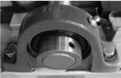
FIGURE 12. Pompez de la graisse dans les deux points de graissage des paliers du rotor, un de chaque côté du rotor.
