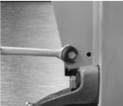
FIGURE 30. Après avoir retiré le(s) boulon(s) de réglage, desserrez le boulon de pivotement inférieur.
