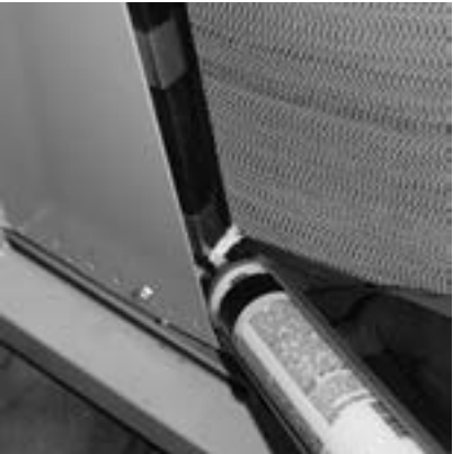
FIGURE 31. . Après avoir ajusté la purge et serré les boulons de réglage et de pivotement inférieur, appliquez du mastic silicone là où le racloir de purge rejoint la plaque frontale de purge.
