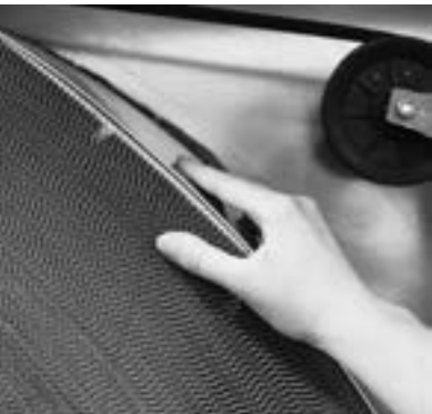
FIGURE 15. Faites tourner le rotor au moins trois tours dans le sens indiqué par la flèche de rotation.
