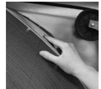
FIGURE 12. Faire tourner le rotor d'au moins trois tours dans le sens indiqué par la flèche de rotation.
