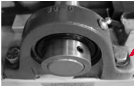
FIGURE 13. Inspectez le collier de roulement pour vous assurer que tous les boulons et vis sont serrés.
