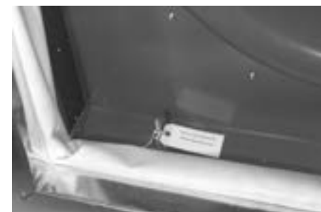
FIGURE 16. Deux dispositifs de retenue dans l'entrée du ventilateur qui fixent le ventilateur au rail de base.
