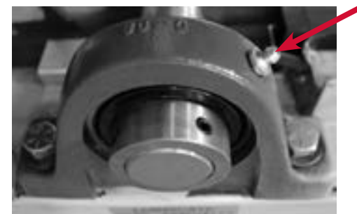
FIGURE 9. Pompez de la graisse aux deux points de graissage de roulement de rotor, un de chaque côté du rotor.
