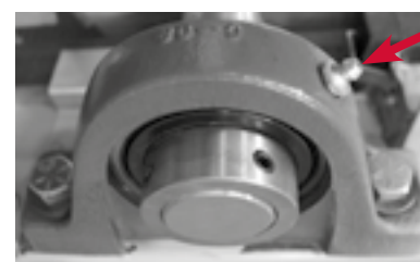
FIGURE 15. Pompez la graisse dans deux points de graissage des roulements du rotor, un de chaque côté du rotor.
