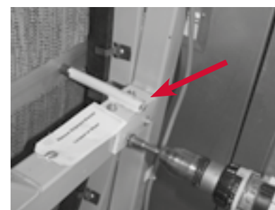
FIGURE 16. Dispositif de retenue d'expédition pour roue à jante plate.
