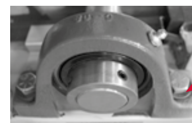
FIGURE 19. Inspectez le collier de roulement pour vous assurer que tous les boulons et vis sont serrés.
