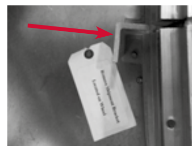
FIGURE 17. Dispositif de retenue d'expédition pour roue à jante nervurée.
